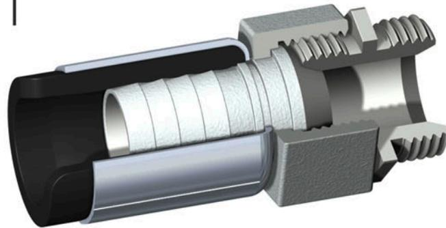
La boquilla con cono hermético es cerrada con la manguera + terminal engatillado. La tuerca giratoria cierra definitivamente su terminal + junta. Sin pastas u otros componentes. Puede abrirse o cerrarse todas las veces.
