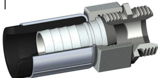
Переходник-«елочка» с уплотняющим конусом опрессован на конце шланга. При помощи накидной муфты обеспечивается легкое скручивание со встречной резьбой. Уплотняющей поверхностью является уплотняющий конус. Нет эффекта перекручивания шлангов.
