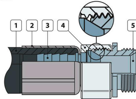
Il becco erogatore con il cono a tenuta sono pressati all'estremità del tubo flessibile.
